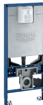
39 596 000 Rapid SLX WC 3-6 | 1,13 m, standardní Instalační rám Rapid SLX pro WC, výška instalace 1,13 m se splachovací nádrží GD2, včetně elektrické zásuvky, s regulátorem průtoku, snadný přístup a kompletní izolace od kondenzující vody
