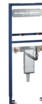
38 625 001 Rapid SL pro bezbariérová umyvadla, jednotvorová nebo nástěnná baterie, podomítková odtoková souprava, nastavitelné mosazné odpadní rameno, chromový potah výška instalace 1,13 m
