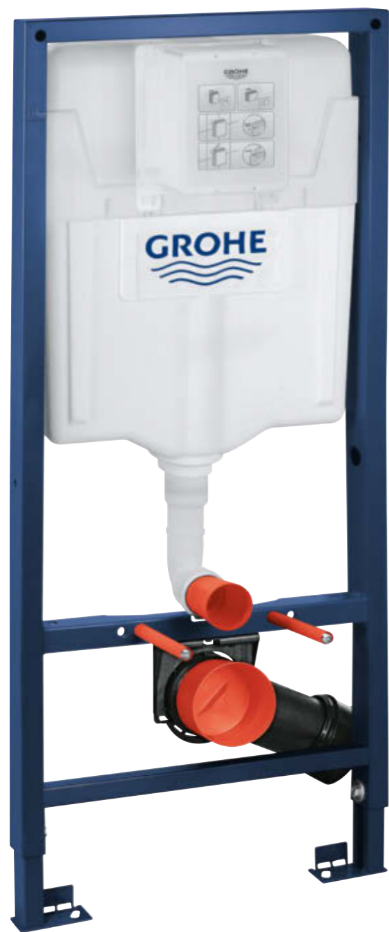
38 528 001 Rapid SL pro WC se splachovací nádrží 6/9 l, duální splachování, start/stop, vodovodní přípojka zleva/zprava/zezadu výška instalace 1,13 m
