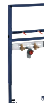
39 052 000 Rapid SL pro umyvadla, nastavitelná výška, jednotvorová baterie, výška instalace 1,13 m, nástěnná nebo podomítková instalace do sádkartonových bloků, 2 odlučňené přípojky DN 15
